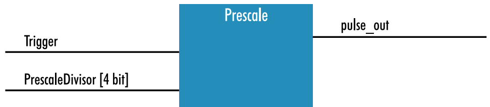
Fig. 5-54: The prescale module
