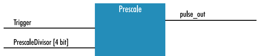
Fig. 5-46: The prescale module
