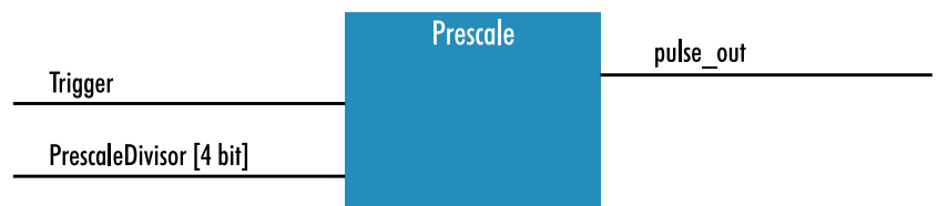
Fig. 5-50: The prescale module
